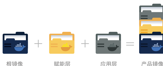
图4-9: 容器镜像的组成
